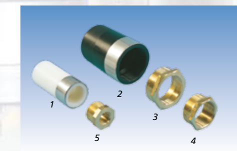
Gewindestutzen und Reduzierstücke 1 PE-Gewindestutzen R 1" Innengewinde 2 PE-Gewindestutzen R 2" Innengewinde 3 Messing-Reduzierstück 2" auf 1½" 4 Messing-Reduzierstück 1½" auf 1¼" 5 Messing-Reduzierstück 1" auf ½"
