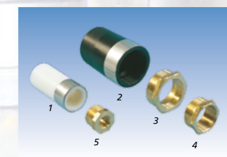
Gewindestutzen und Reduzierstücke 1 PE-Gewindestutzen R 1" Innengewinde 2 PE-Gewindestutzen R 2" Innengewinde 3 Messing-Reduzierstück 2" auf 1½" 4 Messing-Reduzierstück 1½" auf 1¼" 5 Messing-Reduzierstück 1" auf ½"
